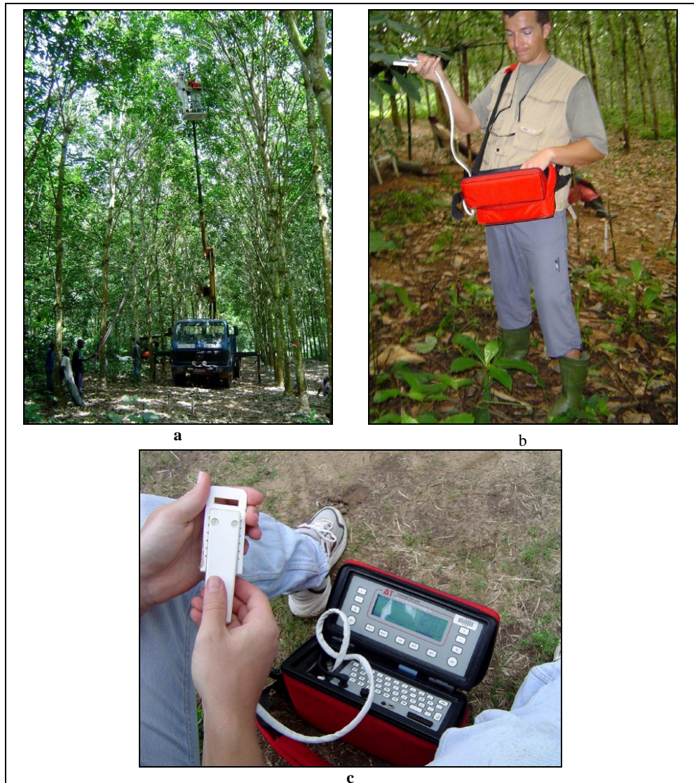
Photo 3abc. Mesures de la résistance stomatique ( r_{\text{stomatique}} , en \text{s cm}^{-1} ) avec un poromètre de type AP4, Delta-T-Devices®. Measurement of the stomatal resistance ( r_{\text{stomatal}} , \text{s cm}^{-1} ), with a AP4 Delta-T-Devices® porometer
